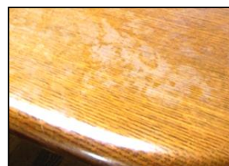
【写真6：塗膜剥離】
