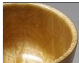
【写真9：液体ガラス塗装】
